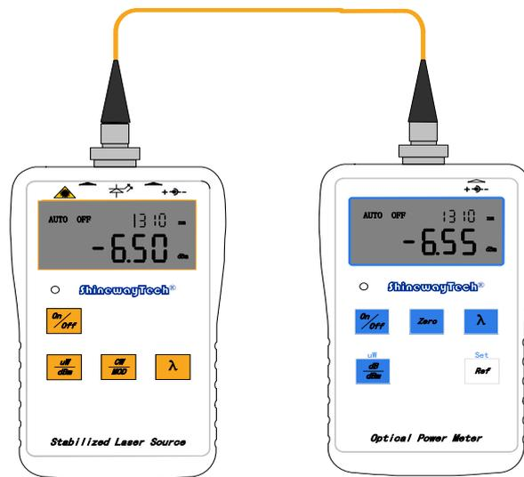
FIGURE17. INITIAL CONNECTION OF CONNECTOR INSERSION LOSS TESTING
