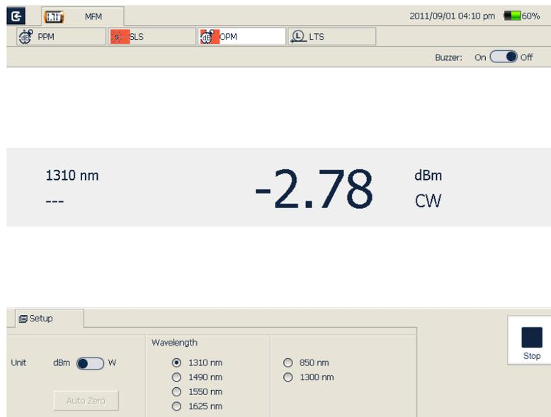
Fig. 16.1 Optical Power Meter
